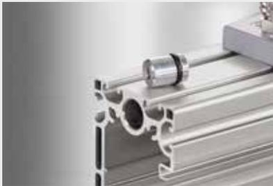
Der Dichtstopfen D19 verschließt einen Druckluftkanal des Installationsprofils 8 160x80 K76 und des Installationssäulenprofils 8 160x160 K76 (0.0.663.39) luftdicht. Damit sie nicht herausgedrückt werden können, empfiehlt sich die verschraubbare Abdeckkappe 8 160x80 für das Installationsprofil bzw. die Abdeckkappe 8 160x160 für das Installationssäulenprofil. Sie sind von den Abdeckkappen entkoppelt, um bei einer Querbelastung der Installationsprofile Undichtigkeiten auszuschließen.
