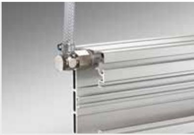
Wenn wenig Platz für einen Druckluftanschluss vorhanden ist, etwa beim Einsatz des Installationsprofils an einem Arbeitstisch, ermöglicht die Schwenktülle G1/2 für Schlauch 9mm einen schwenkbaren und rechtwinkligen Anschluss. Die Grundversorgung mit Druckluft ist somit stufenlos und um 360° schwenkbar möglich.
