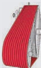
Klasický klíňový řemen Hi-Power® 12 ks B46 (12 ks 17x1180 Li) Šířka řemenice: 234 mm Životnost: 25.000 hod.
