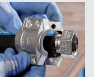
8) V případě potřeby potřít konec koncovky mýdlovým roztokem, nasadit do hadice a přiložit šroubovací objímku (zkontrolovat pozici objímky v bezpečnostním límcí).
