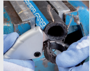
4) Odříznout hadici, lanka se přitom nesmí poškodit
