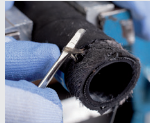
3) Obě měděná lanka uvolnit nožem a kleštěmi a ohnout zpět
