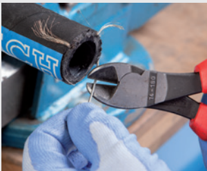
5) Zkrátit ocelovou spirálu štípačkami
