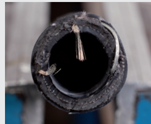
7) Zkrátit měděná lanka, aby přesahovala do hadice minimálně 10mm resp. 1/3 délky koncovky. Zploštit (do šířky) lanka podélně ve směru hadice a ohnout dovnitř.
