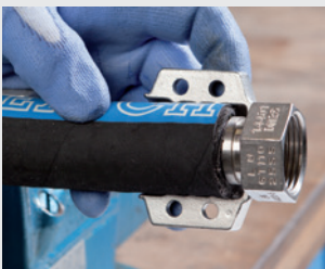
8) V případě potřeby potřít konec koncovky mýdlovým roztokem, nasadit do hadice a přiložit šroubovací objímku (zkontrolovat pozici objímky v bezpečnostním límcí).
