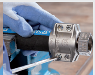
9) Před montáží odmastit závity všech šroubů. Objímku rovnoměrně stáhnout 2 delšími pomocnými montážními šrouby do kříže.
