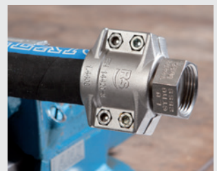
12) Před uvedením do provozu, nejdříve však 24 hodin po první montáži koncovky na hadici, je potřeba ještě jednou dotáhnout šrouby. Hotovo.
