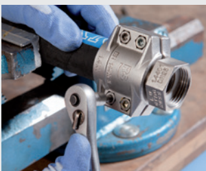
10) 2 pomocné montážní šrouby nahradit dodanými standardními šrouby a dotáhnout do kříže.
