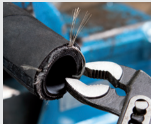
6) Ocelovou spirálu ohnout kleštěmi dovnitř. Konec spirály pevně zamáčknout do duše hadice, aby se při montáži nepoškodila koncovka. Vzdálenost k duši může být cca 3mm.
