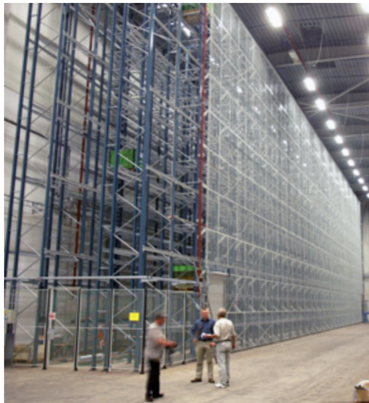
Axelent SafeStore s velikostí oka 60 x 50 mm. Projekt dodaný firmě Scania v Oskarshamnu.
