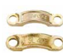
Oben: Original Lüdecke Schlauchklemme DIN 20039. Unten: Plagiat (kein Herstellerkennzeichen, minderwertiges Material)
