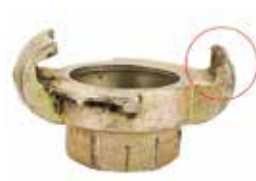
Plagiat (kein Herstellerkennzeichen, minderwertiges Material) – bereits nach kürzester Zeit abgerissene Klaue
