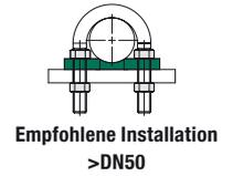
Rundstahlbügel (Typ RB) mit Kunststoff-Rohrauflage (Typ RUL)
