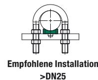
Rundstahlbügel (Typ RB) mit Kunststoff-Rohrauflage (Typ RUK)
